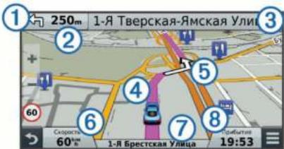
Инструкции о следующем повороте или выезде или другом действии отображаются в верхней части карты. Символ (1) указывает тип действия и полосу или полосы, по которым необходимо двигаться, при их наличии. Также на устройстве отображается расстояние до выполнения следующего действия (2) и название улицы или выезда, связанных с этим действием (3).
