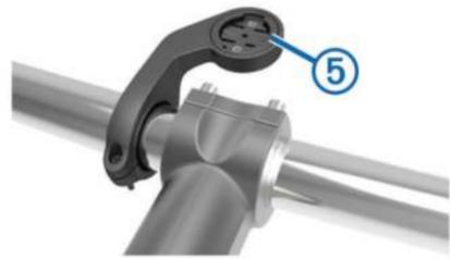
8. Немного нажав на прибор Edge, поверните его по часовой стрелке, чтобы он встал на место.
