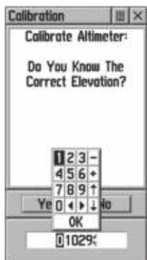
Страница калибровки с клавиатурой с цифрами. Введите известное Вам значение высоты, выделите поле "OK" и нажмите кнопку CLICK STICK для калибровки высотомера
