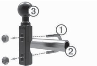
2. Затяните гайки, чтобы закрепить держатель.
