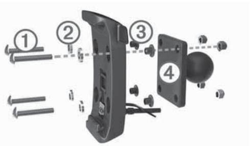
2. Затяните гайки для крепления пластины основания.
