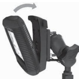
2. Наклоните прибор назад, чтобы он с щелчком встал на место.
