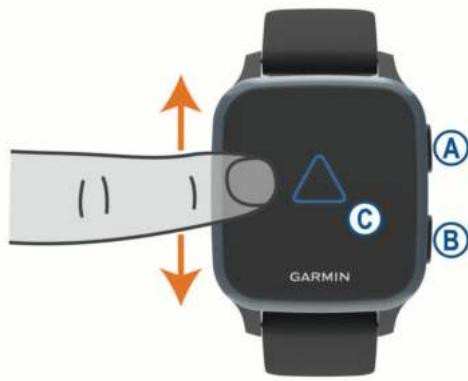
**Ⓐ Кнопка действия:** нажмите, чтобы включить устройство.
