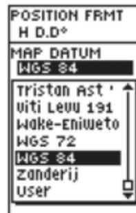
Геодезической системой по умолчанию является WGS 84, хотя для формата координатной сетки пользователя и для настройки геодезической системы пользователя имеются страницы ввода данных.
