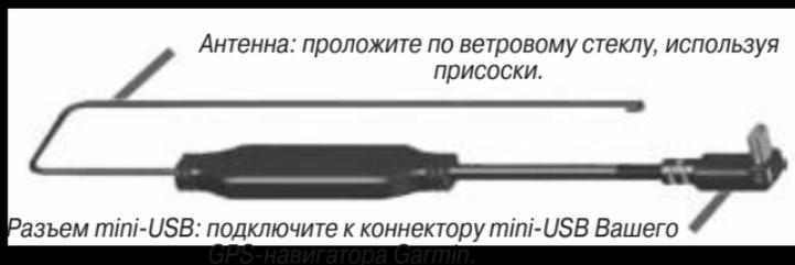
3. С помощью присосок зафиксируйте антенну на ветровом стекле. Для достижения оптимальных результатов располагайте антенну вертикально.
