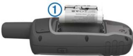
**ПРИМЕЧАНИЕ.** при использовании устройств 64sc/csx в режиме камеры не рекомендуется использовать стандартные щелочные элементы питания.
