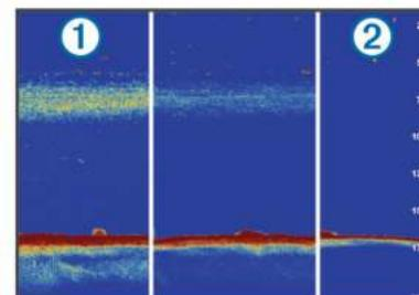
Растяжение эхосигнала и ширина фильтра можно использовать вместе для получения предпочтаемого разрешения и уменьшения шумов. При установке низкого значения для растяжения эхосигнала и ширины фильтра изображение на экране имеет высокое разрешение, но является наиболее восприимчивым к шуму. При установке высокого значения для растяжения эхосигнала
