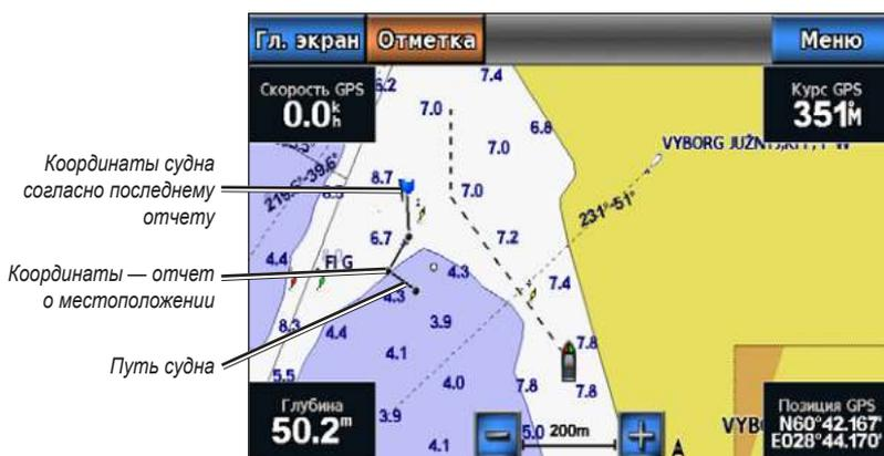
След судна на навигационной карте
