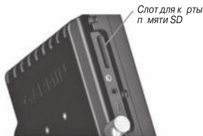
Слот для карт памяти SD в приборе GPSMAP 695/696
