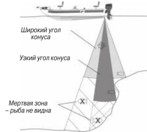
преимущественно в условиях глубоководья. Эти трансдюсеры обеспечивают меньшую зону покрытия (по сравнению с трансдюсерами с широким углом конуса на одной и той же глубине), но в то же время позволяют получить лучшее разрешение дна и меньшую «мертвую зону». Двухчастотные трансдюсеры позволяют использовать преимущества широкого и узкого угла конуса.
