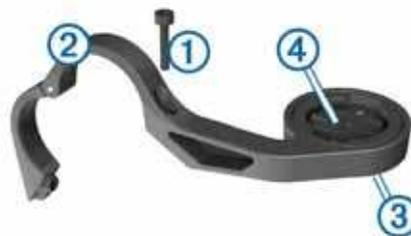
3. Если вы хотите изменить ориентацию держателя, снимите два винта, расположенных на задней поверхности держателя ③, поверните коннектор ④ и верните винты на место.
