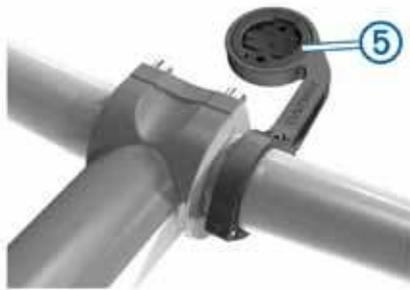
8. Немного нажав на прибор Edge, поверните его по часовой стрелке, чтобы он встал на место.
