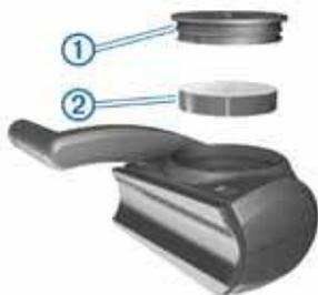
2. С помощью монеты поверните крышку против часовой стрелки, чтобы стрелка на крышке показывала на открытое положение.
