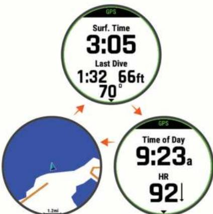
**Экран интервала между погружениями:** отображение текущего времени интервала между погружениями, а также прошедшего времени, максимальной глубины и температуры при последнем погружении в режиме апноз.
