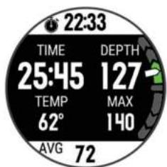
3 Нажмите кнопку **START** и выберите **Сбросить среднюю глубину**, чтобы установить текущую глубину в качестве средней глубины.
