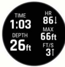
**Экраны данных погружения:** отображение информации о текущем погружении, включая прошедшее время, текущую и максимальную глубину, частоту пульса, а также скорость подъема или погружения.
