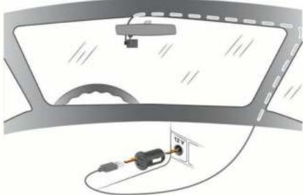
Короткий кабель предназначен для проводки вниз к источнику питания в автомобиле.
