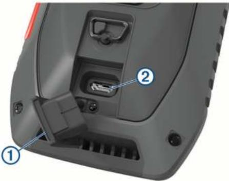
**2** Подключите меньший разъем USB-кабеля к порту mini-USB **②** на устройстве.
