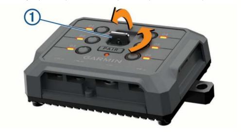
2 Снимите переднюю крышку с устройства.
