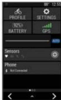
Появится виджет настройки. Мигающий значок означает, что устройство выполняет поиск сигнала. Если значок не мигает, то сигнал был найден или датчик подключен. Можно выбрать любой значок для изменения его настроек.
