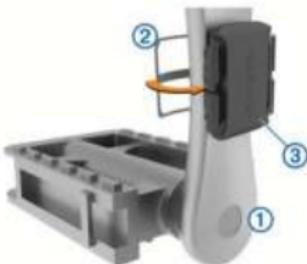
**4.** Проверните шатун педали для проверки зазора.
