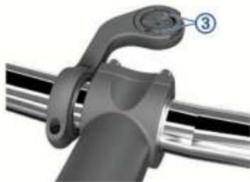
7. Немного нажав на прибор Edge, поверните его по часовой стрелке, чтобы он встал на место.
