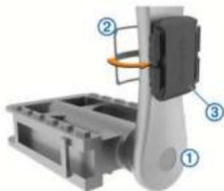
4. Проверните шатун педали для проверки зазора.
