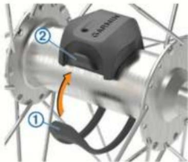
При установке датчика на ассиметричной втулке он может быть наклонен. Это не влияет на работу датчика.
