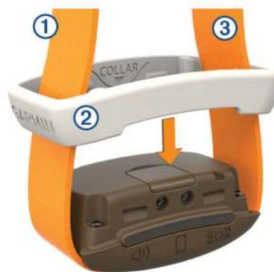
2 Протяните примерно на две трети ремешок ошейника сквозь отверстие ③ на противоположной стороне устройства.
