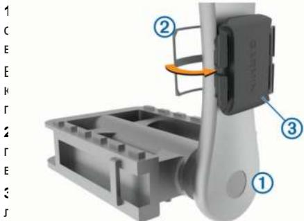
4. Проверните шатун педали для проверки зазора.
