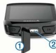
2. Вставьте малый разъем USB-кабеля в порт USB на устройстве. Вставьте большой разъем USB-кабеля в адаптер переменного тока или в компьютерный USB-порт.
