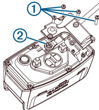
**3** Открутите винт **2**, при помощи которого VHF-антенна крепится к задней панели.
