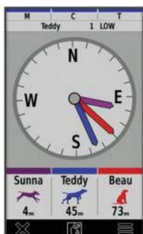
С помощью компаса для отслеживания собаки можно следить за направлением движения и расстоянием до собаки, транспортного средства и любого сопряженного устройства. Компас для отслеживания собаки также показывает ее состояние, например бег или стойку (*Значки состояния собаки*, стр. 6). Цвет указателя совпадает с цветом трека.
