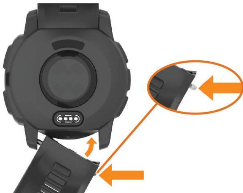
**ПРИМЕЧАНИЕ.** убедитесь, что ремешок закреплен надежно. Штырек часов должен входить в отверстия на устройстве.
