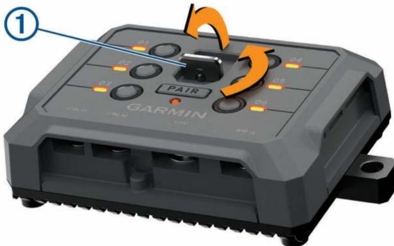
2 Снимите переднюю крышку с устройства.
