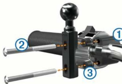
**ПРИМЕЧАНИЕ.** в комплект входят стандартные болты 1/4 дюйма и болты М6. Подберите болты размера заводских болтов на кронштейне зажима сцепления или тормоза.
