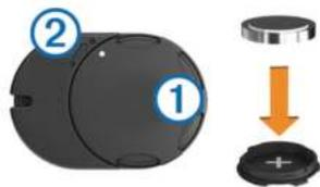
2 Поворачивайте крышку против часовой стрелки, пока она не открутится.
