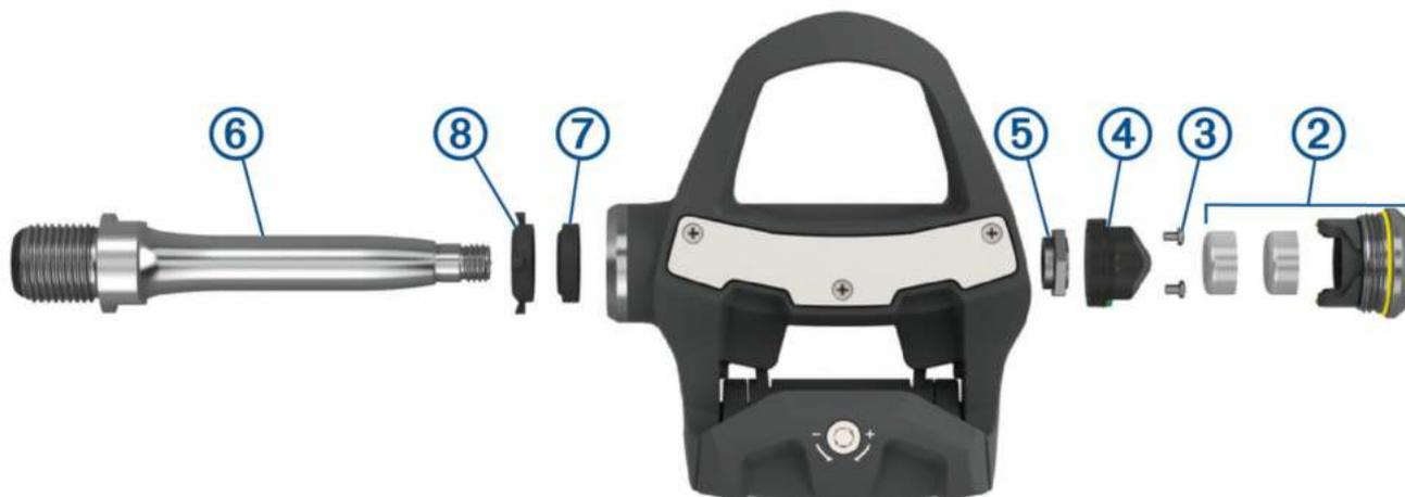
4 С помощью малой крестовой отвертки (PH 00) снимите два винта ③ с внутренней части батарейного держателя ④ .
