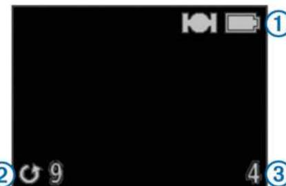
Устройство будет вести съемку через заданный интервал времени. На видоискателе отображается уровень сигнала GPS, уровень заряда аккумулятора **1**, время до следующего снимка в секундах **2** и количество сделанных снимков **3**.
