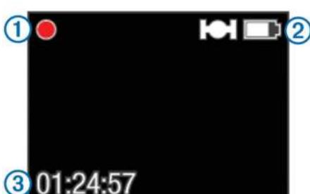
Видоискатель отобразит состояние записи ①, GPS и состояние заряда аккумулятора ②, а также оставшееся время записи ③.
