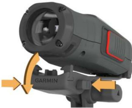
Правильно закрепленная камера должна быть прочно зафиксирована и не должна двигаться в держателе.
