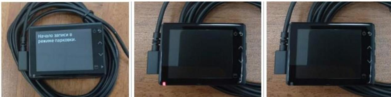
Если произойдет событие, и камера зарегистрирует движение, то камера перейдет в режим записи события и светодиод на время этой записи будет непрерывно светиться красным цветом.
